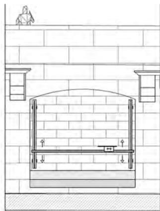
1. Installation de rails et fixation de la scie murale
